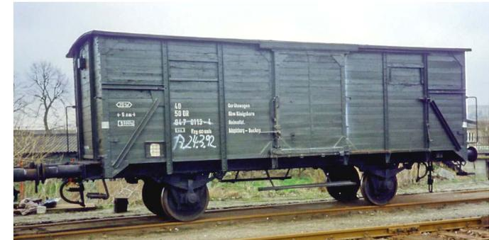
Der von der **SndB** finanzierte G10. Sein langes Untergestell erlaubt die Rekonstruktion des früher typischen Bremserhauses. Mit einst über 200.000 Stück ist der G10 Deutschlands meistgebautes Bahnfahrzeug!
